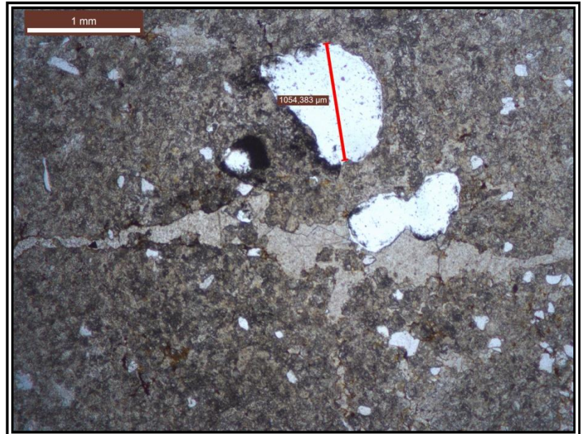
Figura 1: Detalle de la porosidad vacuolar, tamaños en torno a 0,1 mm. Microfractura sellada en su totalidad
